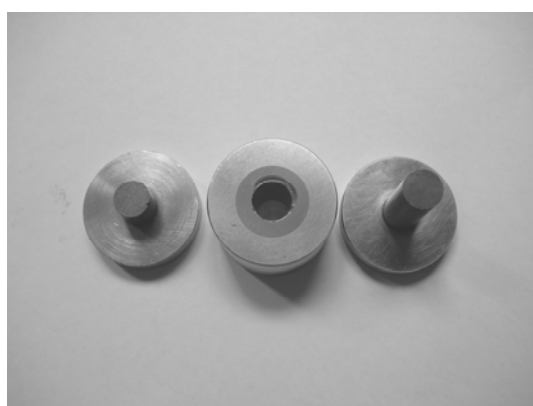
圖 3 粉壓胚成型模具(左：下模，中：母模，右：上模)
